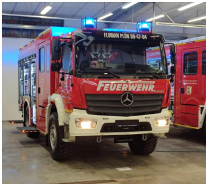
Das neue Feuerwehrfahrzeug verfügt über einen Löschmitteltank von 1200 Litern, einen Lichtmast, eine eingebaute Pumpe mit einer Leistung von 2000 Liter bei 10 Bar und über eine portable Pumpe mit einer Leistung von 1500 Liter bei 10 Bar Druck. Zur Beladung des Fahrzeuges gehören unter anderem 4 Atemschutzgeräte, von denen sich 2 im Mannschaftsraum befinden, diese Atemschutzgeräte können schon auf der Anfahrt zum Einsatzort angelegt werden.
